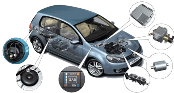
Рис. 3. Газобалонне обладнання сучасного автомобіля
